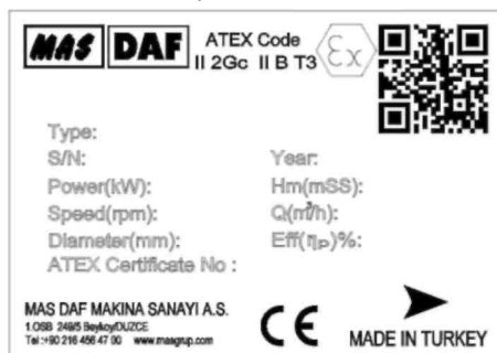
Рис. 2: Паспортная табличка насоса ATEX
