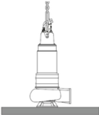
Рис 7 Выгрузка насоса: установка
